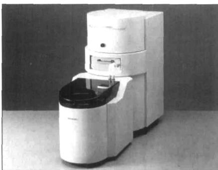
▲ **Laser Diffraction Particle Analyzer:**
