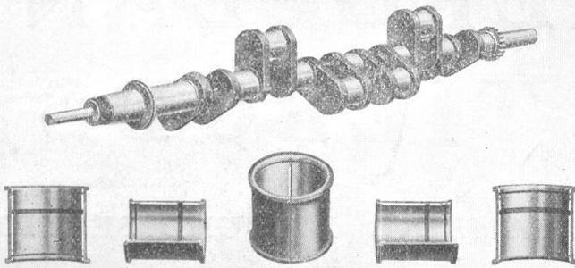
— AERO. ENGINE CRANK-SHAFT AND BEARINGS. —
