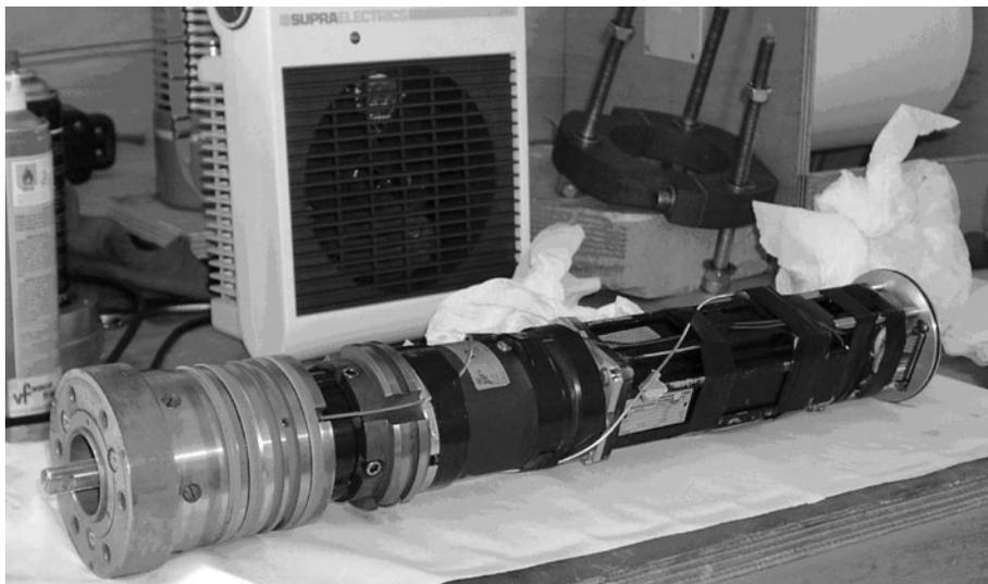
**Fig. 7.** Motor module.
